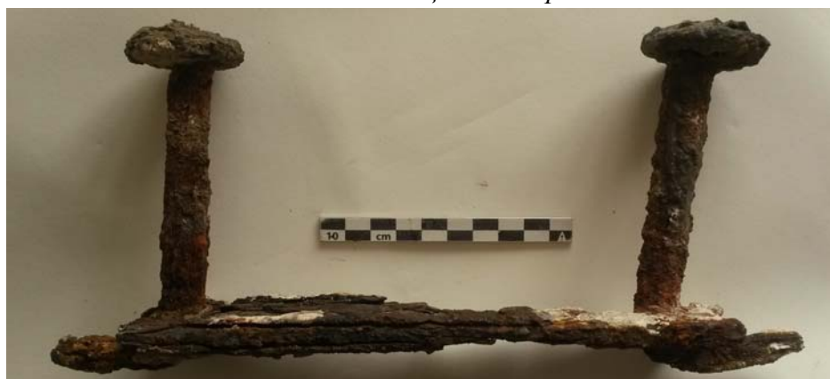
Рис. 4. Скоба, соединяющая составные доски панно
